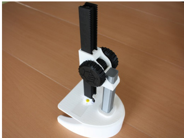
Figure 3. Thingiverse © propose de nombreux fichiers imprimables gratuits, comme les plans pour cette base de microscope. Ajoutez-y les bonnes lentilles et le tour est joué Source : Utilisateur « Kwalus » sur Thingiverse © www.thingiverse.com/thing:77450
